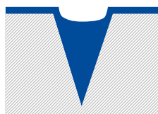
Honovacie štruktúry vyplnené aglomerovaným tuhým mazivom
