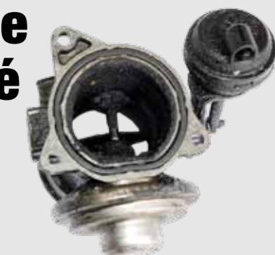
Karbonové usady dokážou zablokovat EGR ventil a způsobit i nedobrovolnou odstávku vozidla, které se začne dusit vlastními výfukovými plyny.
