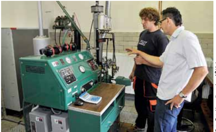
Cetanové číslo se měří na zkušebním jednoválcovém motoru s nastavitelným kompresním poměrem a časováním vstříku. Nejistota měření je +/- jedna jednotka.
