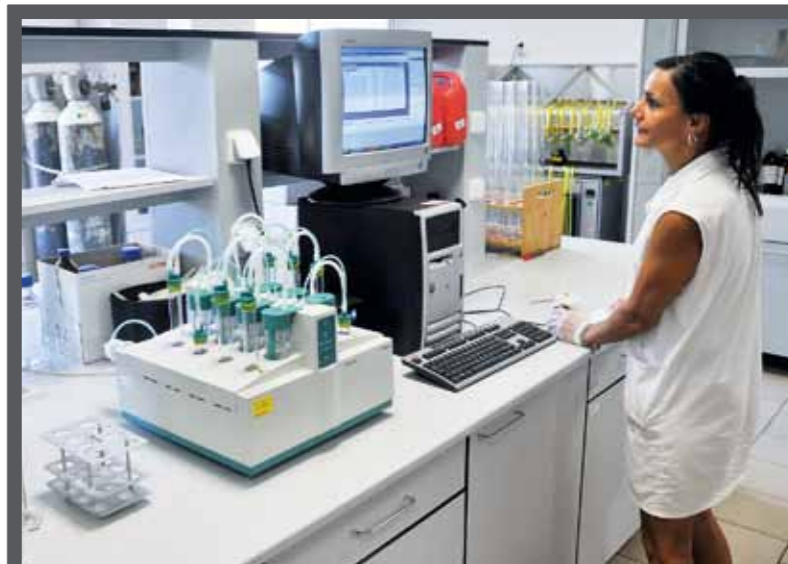
Oxidační stabilita se měří přístrojem Rancimat. Vzduch přečištěný přes molekulová síta probublává vzorkem, který je zahříván na 110 °C. Páry uvolněné během oxidačního procesu jsou vedeny společně se vzduchem do vodivostní cely obsahující demineralizovanou vodu. Do ní je ponořena elektroda pro měření vodivosti. Ta je nepřetržitě měřena během celého oxidačního procesu. Jakmile se začne vodivost rapidně zvyšovat, zkouška se automaticky ukončí a ze získaného grafu se vyhodnotí takzvaná indukční perioda – tedy čas, který uplynul od začátku měření až do doby, kdy začíná rychlý nárůst tvorby oxidačních produktů. V praxi platí, že hodina oxidační stability Rancimat rovná se týdnu v nádrži vozidla. V letním období to však může být citelně méně! Nejistota stanovení výsledku je +/- 0,1 hod.
