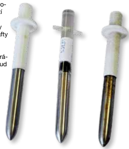
Koroze se měří ponořením ocelových zkušebních tyčinek do směsi hodnocené nafty s destilovanou vodou za současného míchání při teplotě 20 °C po dobu 24 h
