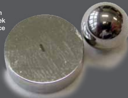
Mazivost se měří metodou HFRR, tedy kmitáním ocelové kuličky po destičce za současného mazání zkoušené nafty. Poté se v mikrometrech (µm) měří korigovaný průměr otěrové plochy. Čím nižší číslo, tím lepší mazací schopnost nafty.
