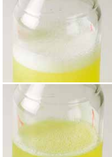
Pěnovost se měří jako čas v sekundách po silném zatřepání průhlednou vzorkovnicí. První číslo představuje čas, za který vznikne na hladině první lysinka, druhé ten, za nějž pěna zcela zmizí.
