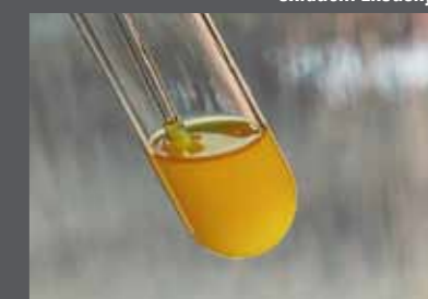
V detailu vzorek nafty po ukončení oxidační zkoušky
